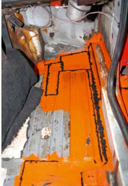
Mijn eigen gerepareerde vloer met allerlei nieuwe lasnaden, goed in de menie gezet. Dit zit alweer tien jaar op zijn plek
