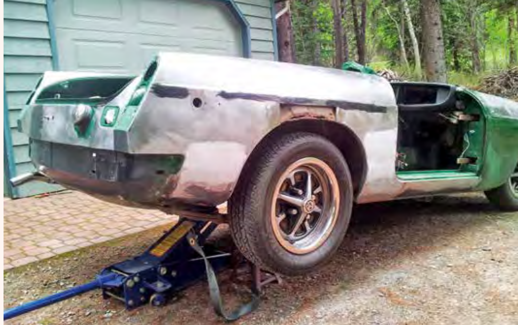
De plekken plamuur en het gat geven de zwakke plekken keurig weer!
